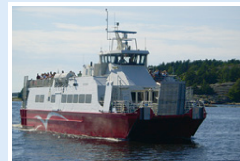
Kostersund SMFL Byggt i Aluminium vid Båtservice Industrier A/S - Mandal 1992. Maskineri: 2 st Scania DI16M (2010) totalt 1200 hk. Längd: 32,00 m, Bredd: 9,24 m, Fart: 18 knop Marschfart 10-14 knop Historik: 1992-2007 Beinveien, 1992-2000 Vesttrafik A/S, Bergen 2000-2006 Hardanger Sunnhordlandske Dampskipsselskap (HSD), Bergen 2006-2007 Tide Sjø A/S, Bergen
