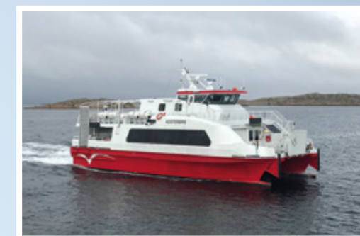
Kosterbris SDYZ Byggt i aluminium vid Oma baatbyggeri A/S, Stord 2005 Maskineri: 2 st Scania DI16M (2017), totalt 1200 hk. Längd: 25,96 m, Bredd: 9,0 m, Fart: 20 knop Historik: 2005-2015 SNARVEIEN, Bergen Nordhordland Rutelag A/S
