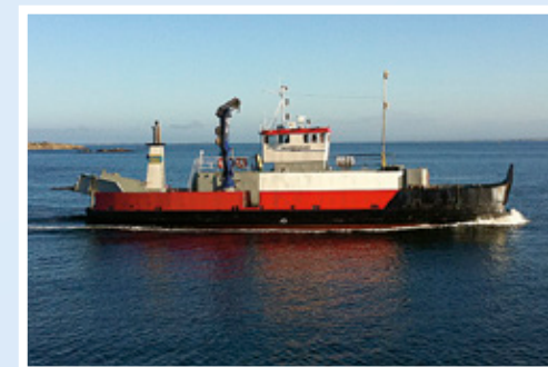
Kosterfärjan SJBH Byggt i stål vid Åsi-verken, Åmål, 1957. Huvudmaskineri: 1 st Scania DI16M, 550 hk (2013). Längd: 28,0, Bredd: 8,0 m, Fart: 10 knop Kran: 24 ton, max 5000 kg Historik: 1957-84 Färja 61/216, Statens Vägverk, Borlänge
