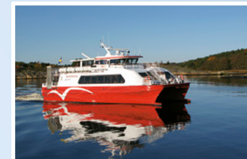
Kostervåg SLTA Byggt i aluminium vid Oma baatbyggeri A/S, Stord 2000. Maskineri: 2 st Scania DI16M (2015), totalt 1200 hk. Längd: 25,75 m, Bredd: 9,0 m, Fart: 20 knop
