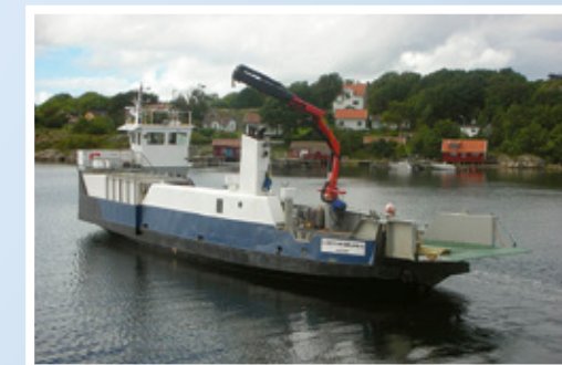
Kosterfärjan 4 SJBC Byggt i stål vid Åsi-verken, Åmål, 1957. Huvudmaskineri: 1 st Volvo Penta D16, 550 hk (2008). Längd: 28,0, Bredd: 8,0 m, Fart: 10 knop Kran: 27 ton, max 5200 kg Historik: 1957-79 Färja 61/214, Statens Vägverk, Borlänge 1979-2007 diverse ägare under namnen Arven, Betania och Sandraia
