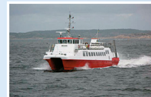
Kosterfjord SDJG Byggt i aluminium vid Westermoen Hydrofoil A/S, Mandal 1971. totalrenoverad 1995-97 Maskineri: 2 st Volvo Penta D16 (2007), totalt 1440 hk. Längd: 26,45 m, Bredd: 9,02 m, Fart: 18 knop Marschfart: 10-16 knop Historik: 1971-95 Fjordgylt, Fylkesbaatene i Sogn og Fjordane, Florø
