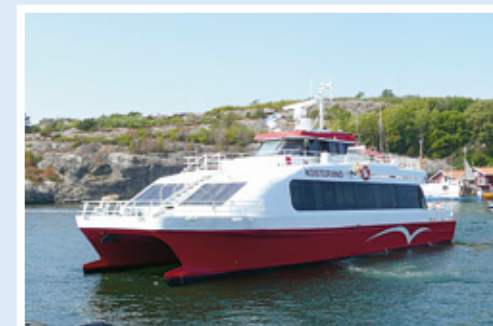
Kostervind SHRY Byggt i aluminium vid Oma baatbyggeri A/S, Stord 1995. Kostervind sköter forbindelsen till Ramsö och är därtill reservbåt. Maskineri: 2 st Scania DI13M (2017), totalt 1400 hk. Längd 19,8 m, Bredd 8 m, Djupg. 1,0 m, Fart 20 knop Historik: 1995-2014 Vøringen, i trafik på norske västkusten, HSD/Tide/Norled.
